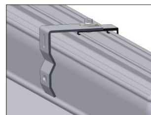
Standardowy montaż ścienny
