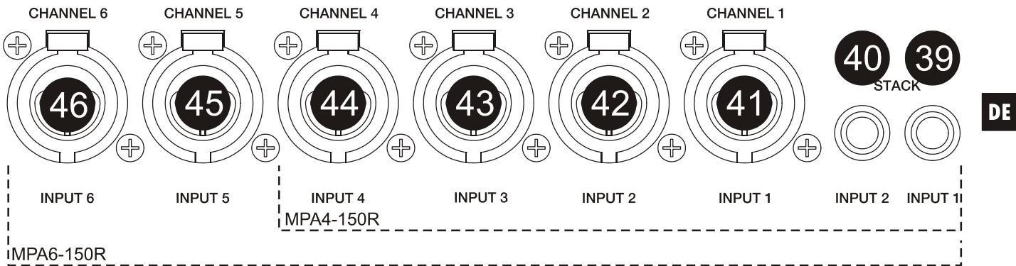
Die Eingangsbuchsen des MPA R (41, 42, 43, 44, 45, 46) sind elektronisch symmetrierte XLR-Buchsen mit einer Eingangsimpedanz von  $>20\text{k}\Omega$  und einer Nennempfindlichkeit von 0dBV(1V). Die Pinbesetzung ist:
