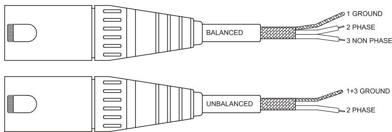
Die "STACK" Anschluss (39, 40) sind mit den Eingängen "INPUT 1 INPUT 2" parallel geschaltet und werden verwendet, um das gleiche Eingangssignal zu anderen Verstärkern oder Geräten zu senden. Diese Signalausgänge sind mit  $\frac{1}{4}$ " Klinkenbuchsen ausgestattet. Die Pinbelegung der Anschlüsse ist wie folgt:
