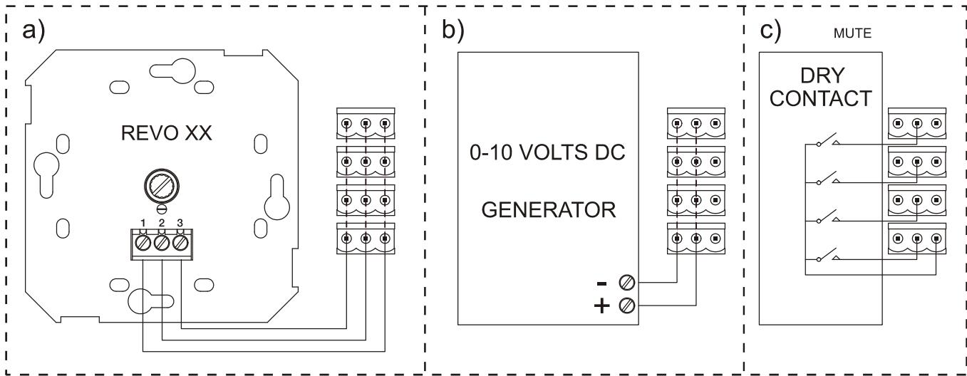
NOTA: Puede conectar un máximo de 16 entradas en paralelo a un mismo potenciómetro de control. Es imprescindible que todas las masas de los amplificadores estén unidas.
