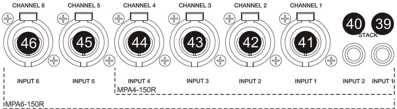
Las entradas de señal (41, 42, 43, 44, 45, 46) son del tipo XLR-3 balanceadas electrónicamente, con una impedancia de entrada superior a  $20\text{k}\Omega$  y una sensibilidad nominal de 0dBV(1V). La asignación es la siguiente:
