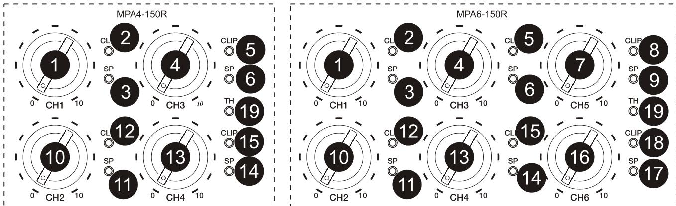
Ces atténuateurs permettent de connecter différentes consoles de mixage, de régler le volume de façon indépendante et de brancher des HP pouvant supporter une puissance inférieure à celle administrée par l'amplificateur à plein rendement, sans aucun danger de les endommager par une manipulation exagérée du volume de la console de mixage.
