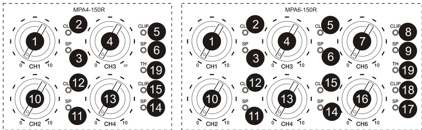
Estos atenuadores posibilitan la conexión a distintos tipos de mesas, regulación de nivel independiente y conexión de altavoces que soporten una potencia inferior a la suministrada por el amplificador a pleno rendimiento, sin peligro de dañarlos por un descuido al manejar el volumen del preamplificador-mezclador.
