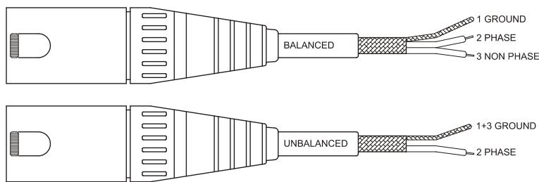
Los conectores "STACK" (39, 40) están en paralelo con las entradas y sirven para conectar la misma señal que tenemos en las entradas "INPUT 1, INPUT 2" a otros amplificadores o sistemas de sonido. Estos conectores son del tipo jack 1/4" siendo la asignación de patas la siguiente:
