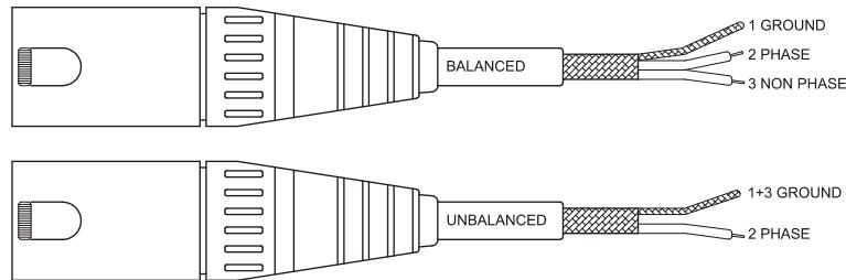
Les sorties "STACK" (39, 40), sont en parallèle avec les entrées "INPUT 1 INPUT 2" et servent à brancher le même signal, que nous avons sur les entrées "INPUT", à d'autres amplificateurs ou à d'autres sources de son. Elles sont de type jack 1/4" et l'assignation est la suivante:
