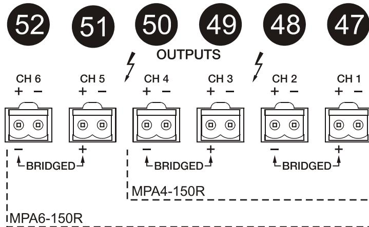
Connectez les blocs de jonction en toute sécurité, en ôtant l'extrémité de la gaine du câble sur 5 à 7 mm.
