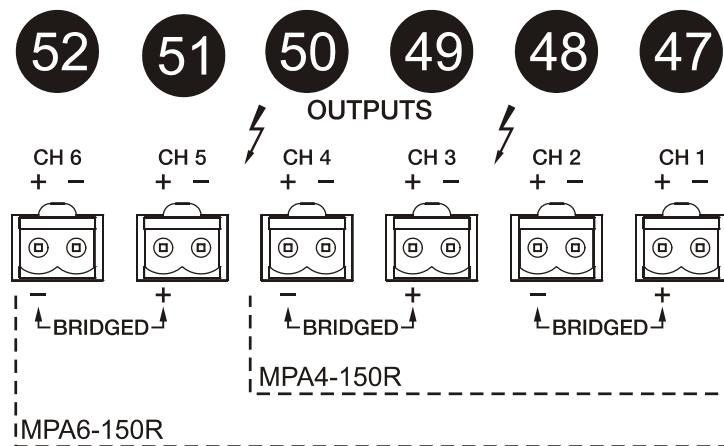
Conectar los terminales de seguridad, pelando la cubierta del extremo del cable entre 5-7mm.
