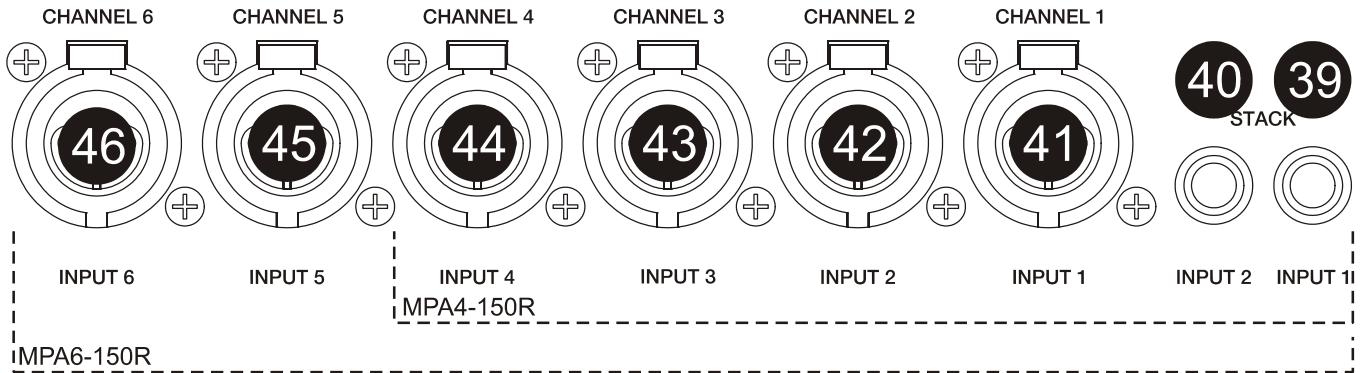
Les entrées du signal (41, 42, 43, 44, 45, 46) sont de type symétriques XLR-3 avec une impédance d'entrée supérieure à  $20\text{k}\Omega$  et une sensibilité nominale de 0dBV(1V). L'assignation est la suivante:
