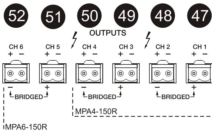
Verbinden Sie die Klemmleisten sicher, indem Sie den Kabelmantel 5÷7 mm vom Ende entfernen.
